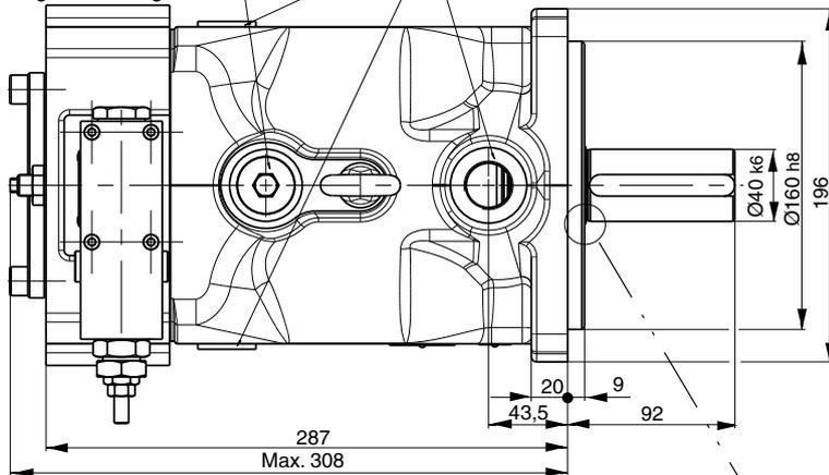
Manometeranschluss M: G1/4" optional M12 x 1,5; ISO6149-1 (Gewindeoptionen 7 und 8) oder 7/16"-20 UNF (Gewindeoption 3)
