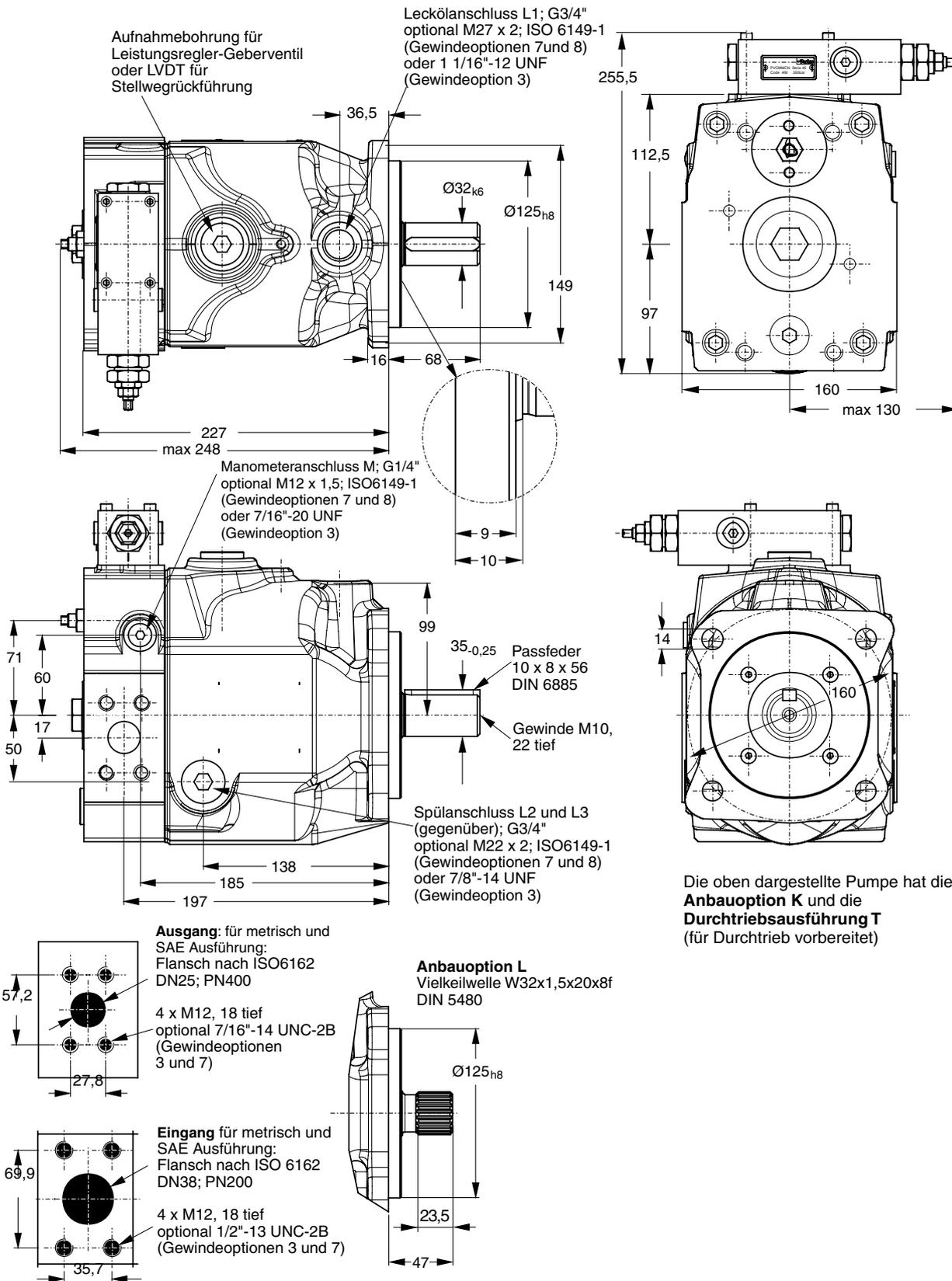
Dargestellt ist hier die Ausführung mit Standard Druckregler, code \*MMC, und Drehrichtung „rechts“. Bei Drehrichtung „links“ liegen die Anschlüsse spiegelbildlich.
