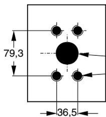
**Eingang** für metrisch und SAE Ausführung; Flansch nach ISO 6162 DN 102; PN 35 bar 4"
