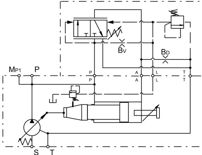
Die Ansprechzeiten der Pumpe wurden in dem unten dargestellten Hydraulikkreis durch Messung der Schwenkbewegung der Pumpe ermittelt.
