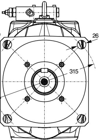
Die oben dargestellte Pumpe hat die **Anbauoption K** und die **Durchtriebsausführung T** (für Durchtrieb vorbereitet)
