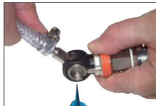
Kupplung ausschwenken - Kupplung schließt und entlüftet
