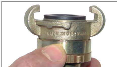
Vorgeschaubte Dichtung - Verbindung ist dicht.
