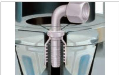
Schlauch von unten in die Pressbackenaufnahme schieben und auf Anschlag setzen.
