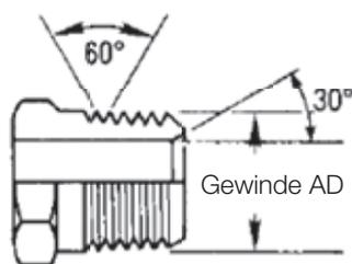
ØA Abmessungen werden an der 4. Gewindespitze gemessen
