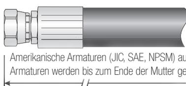
Amerikanische Armaturen (JIC, SAE, NPSM) außer ORFS-Armaturen werden bis zum Ende der Mutter gemessen.
