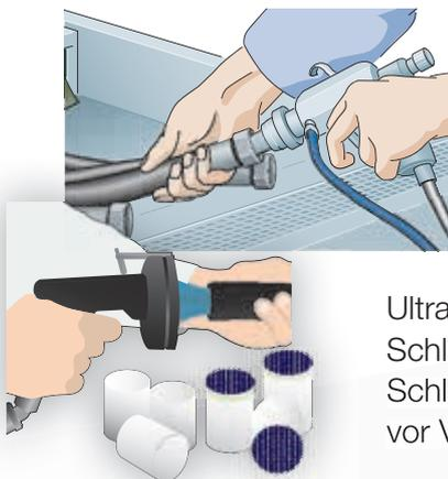
leitung mit einem Reinigungs- und Korrosionsschutzmittel und bläst sie dann mit Druckluft aus. Die Trockenreinigungssysteme TH6-10-EL-7 oder TH6-10-HL-9-2 schießen ein Ultra Clean Projektil komplett durch den Schlauch. Schützen Sie zum Schluss die Schlauchleitung mit Plastikstopfen vor Verschmutzung.
