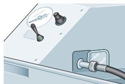
Je nach Schlauchtyp und Anwendung wird der statische Prüfdruck für eine vorgegebene Zeit auf die fertige Schlauchleitung gegeben. Das Testverfahren kann mittels einer Prüfprotokolleinheit dokumentiert werden. Der Prüfdruck bei Parker-Hydraulikschlauchleitungen beträgt das Zweifache des Wertes des maximalen dynamischen Betriebsdrucks.
