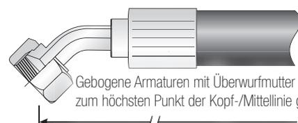
Gebogene Armaturen mit Überwurfmutter werden bis zum höchsten Punkt der Kopf-/Mittellinie gemessen.
