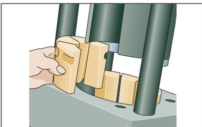
Gewünschten Backensatz in die Backenaufnahme einsetzen. Eine Backenhälfte hinten, eine vorne einlegen, um das Herausnehmen von Rohrbogen-Armaturen zu erleichtern.
