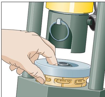
4. Backenring entsprechend des Schlauchtypes auf Pressbackensatz aufsetzen (s. Pressmaß-Tabelle).
