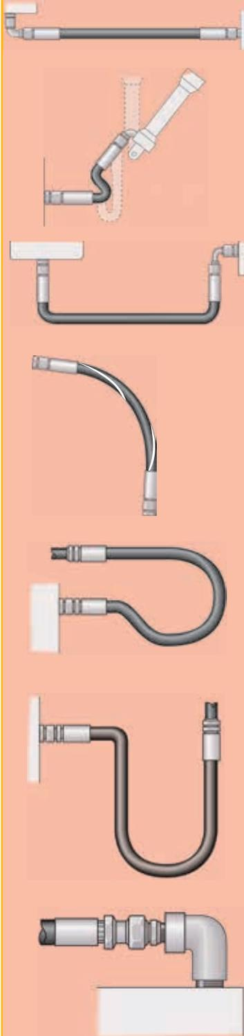
Das **Verlegen** der Schlauchleitung und die Umgebung, in der sie betrieben wird, beeinflussen unmittelbar die Lebensdauer einer Schlauchleitung. Die folgenden Diagramme zeigen die sachgemäße Verlegung von Schlauchleitungen, die deren Lebensdauer maximieren und eine sichere Funktionsfähigkeit gewährleisten.
