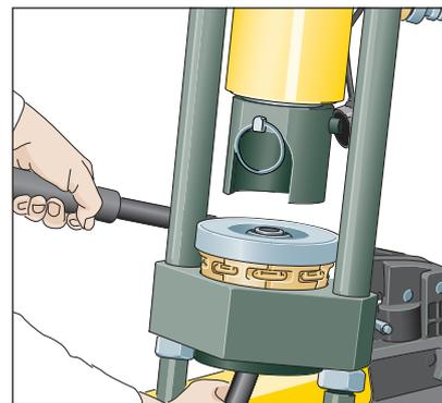
5. Mittels Blockierstift Pressstempel ausrichten. Rücklaufventil an der Pumpe schließen, Handpumpe betätigen bis Backenring auf Grundplatte aufsitzt.
