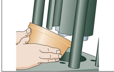
Adaptoreinsatz in die Backenaufnahme einlegen. Dabei leicht kippen und richtig positionieren.
