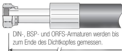
DIN-, BSP- und ORFS-Armaturen werden bis zum Ende des Dichtkopfes gemessen.
