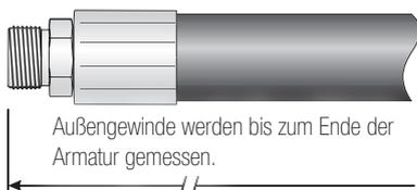
Außengewinde werden bis zum Ende der Armatur gemessen.
