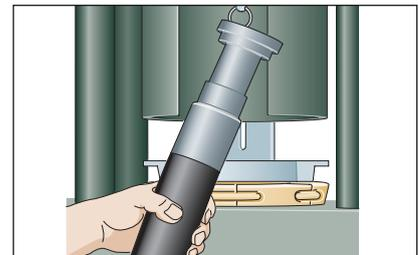
Danach oberen Knopf drücken bis Armatur herausgenommen werden kann. Die verpresste Armatur darf nicht herausgenommen werden bevor die vordere Hälfte des geteilten Pressringes entfernt wurde.
