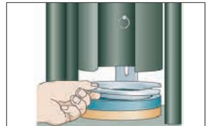
Andere Hälfte des Backenringes einsetzen. Nut- und Federring dient zum Ausrichten der beiden Hälften.
