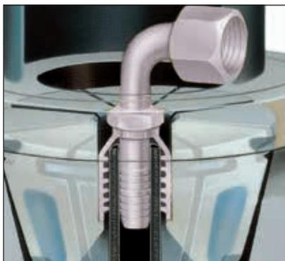
3. (a) Schlauch von unten in den Backensatz einlegen und auf Anschlag (Stop) setzen.
