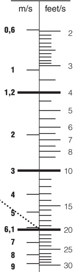
max. empfohlene Strömungsgeschwindigkeit bei Saugleitungen
