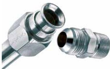
Die Triple-Lok Bordelverschraubungen sind auf bis zu 500 bar Nennndruck mit 4-fachem Sicherheitsfaktor Standards: ISO 8434-2, SAE J514 ausgelegt. Alle Verschraubungen haben eine Cr(VI) freie Oberfläche und übertreffen mit einem Korrosionswiderstand von 120 Stunden gegen Weißrost den Standardwert der Branche.
