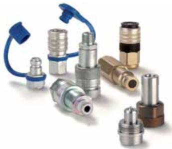
Schnellverbinder, die den Vorteil ihrer Eignung für hohe Drücke mit einer bewährten Konstruktion verbinden: Bündig gestalteter Kegel zur Verminderung der Leckage, Gewinde-Ausführungen für einen Anschluss unter Druck, Kugel-Schließmechanismus für einen einfachen und schnellen Einsatz. Die meisten Ausführungen sind mit vergleichbaren Konstruktionen austauschbar.
