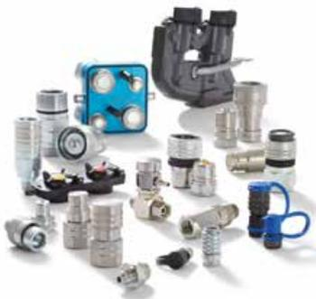
Wir haben für jeden Einzelfall eine Lösung: Die Baureihe 60 für den allgemeinen Bedarf erfüllt die Norm ISO 7241-1-B, Baureihe FEM gemäß ISO 16028 mit flach ausgeführtem Kegel zum Schutz von Arbeitsplatz und Umgebung, Baureihe FS aus Edelstahl für den Einsatz bei korrosiven Fluiden oder Baureihe ST ohne Ventile für hohen Durchfluss und geringen Druckverlust.
