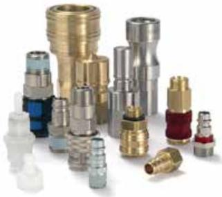
Einsteck-Schnellverbinder, die die Anforderungen des „Europäischen Profils“ gemäß ISO 6150-B oder ISO 6150-C erfüllen. Auch mit verbesserten Durchfluss-Kennlinien lieferbar, die den Einsatz bei allen pneumatischen Ausrüstungen erlaubt. Das Angebot wird durch Sicherheits-Versionen gemäß Norm ISO 4414 vervollständigt, mit denen ein Verschlagen des Schlauches bei Trennung verhindert werden soll.
