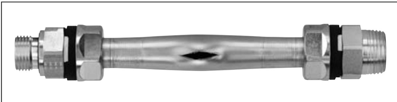
Eine sorgfältig montierte EO-Verschraubung bleibt bis zum Bersten des Rohres dicht. Erfahrungsgemäß können Funktionsstörungen, Nachziehen und Leckagen durch die Beachtung folgender Sicherheitshinweise vermieden werden.
