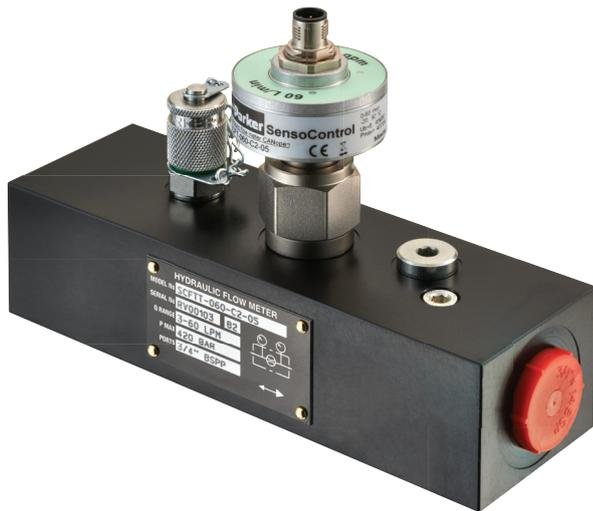
Ein Turbinenrad wird durch den Ölstrom angetrieben und in Drehung versetzt. Die erzeugten Frequenzen werden durch eine digitale Elektronik aufbereitet. Die Einflüsse von störenden Strömungseffekten werden kompensiert. Durch den geringen Durchflusswiderstand  $Q_R$  wird der Hydraulikkreislauf verlustarm betrieben.
