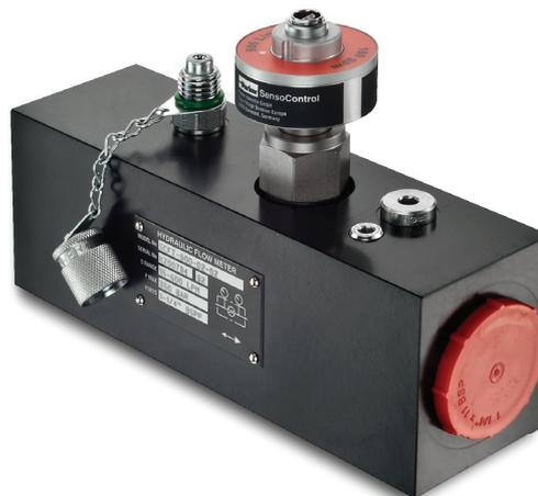
Ein Turbinenrad wird durch den Ölstrom angetrieben und in Drehung versetzt. Die erzeugten Frequenzen werden durch eine digitale Elektronik aufbereitet. Die Einflüsse von störenden Strömungseffekten werden kompensiert. Durch den geringen Durchflusswiderstand  $Q_R$  wird der Hydraulikkreislauf verlustarm betrieben.
